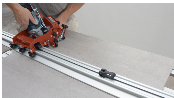
Skäring av plattor efter styreskinne
