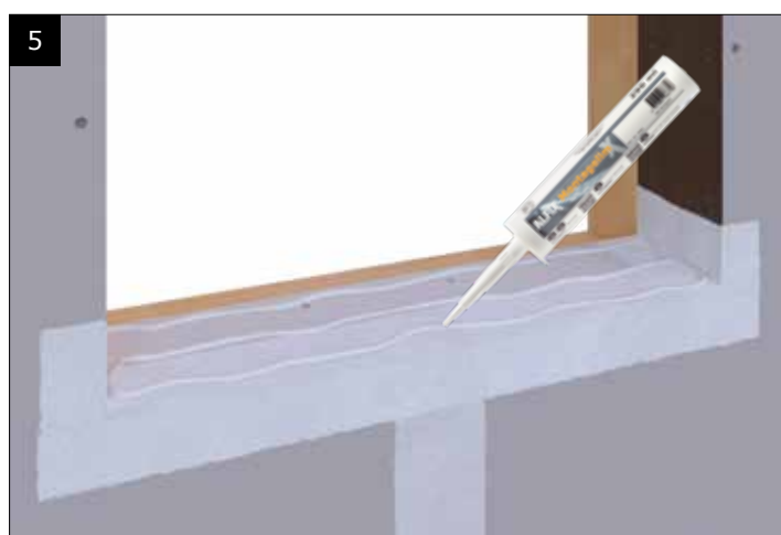
5 Til klæbning af f.eks. tilplasset alu-sålbænk anvendes Alfix Montagemlim. (Tømrer/blikkenslager)
