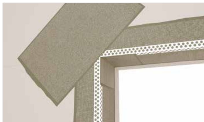
Ekstra forstærkning med stykker af armeringsnet
