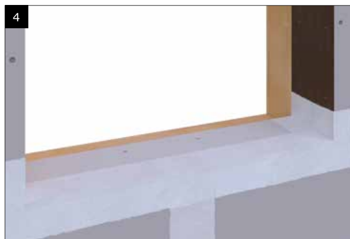
4 Den pudsbærende facadeplade armeres i samlingerne efter pladeproducentens anvisninger- (Tømrer)
