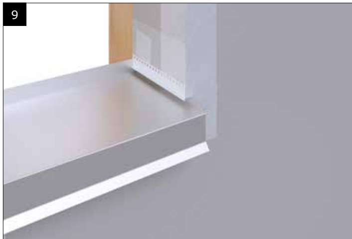
Tilpas Alfix Uni-liste til underkant af falsbeklædning. NB! - Det anbefales at beskytte sålbænk mod mørtelspild. (Murer)
