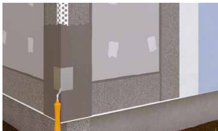
Hjørnelistens armeringsnet trykkes ind i armeringspuds
